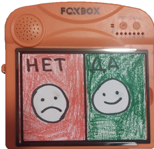
Рис. 13. Кнопка для записи голосовых сообщений. Коммуникатор Foxbox (здесь использованы две ячейки для символов «да», «нет»).
